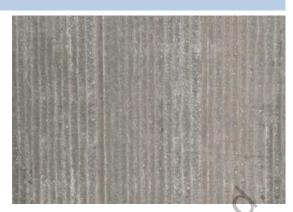
我公司从事耐磨堆焊事业多年,拥有多台自行研发的自动堆焊机。 我们采用目前最先进的焊接工艺以及自行研制生产的优良耐磨焊丝, 在 Q235B 钢板(也可以根据客户需要选择基材)上,堆焊成过共晶高 铬合金复合耐磨钢板。我公司生产的复合耐磨板,金属化合物以比较 弥漫的形式分布于固溶体基材上,并被实际用作强化相,从而使整个 合金的强度、硬度、耐磨性得到很大的提高。
